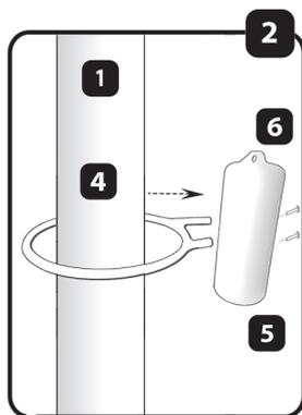
С помощью винтов (5) прикручиваем кольцо противовеса (4) для противовеса мачты (6) в предусмотренном для него месте и нанизываем на мачту флага (4).
