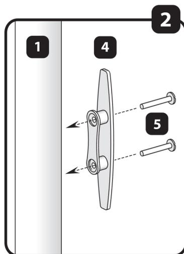
С помощью винтов (5) прикручиваем рукоятку (4) для закрепления веревки на мачте флага (1) в предусмотренном месте – в нижней части мачты.
